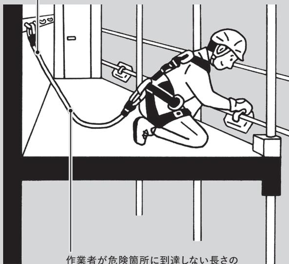
作業者が危険箇所に到達しない長さの伸縮率が低いロープ等をランヤードとして使用する。ショックアブソーバ付きランヤードは、衝撃により伸長の可能性があるため使用してはならない。〈p.054「ショックアブソーバ」の解説を参照〉
